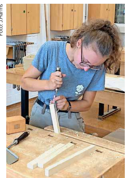
Judith Cramer arbeitet an den Schlitzverbindungen des Wiegengestells.
