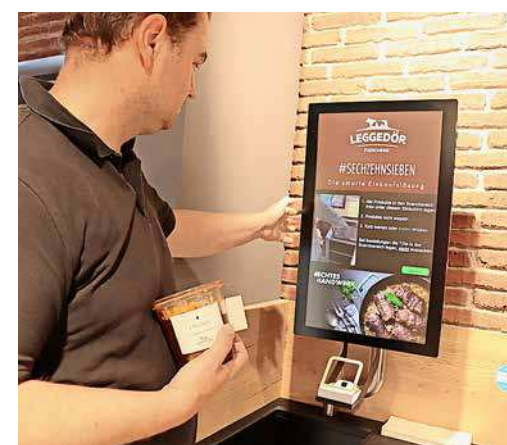
Markus Leggedör zeigt das Kassensystem. An der Ware sind RFID-Codes angebracht, die der Scanner erfasst.
